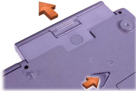
图 2-8：从电池槽中取出电池
